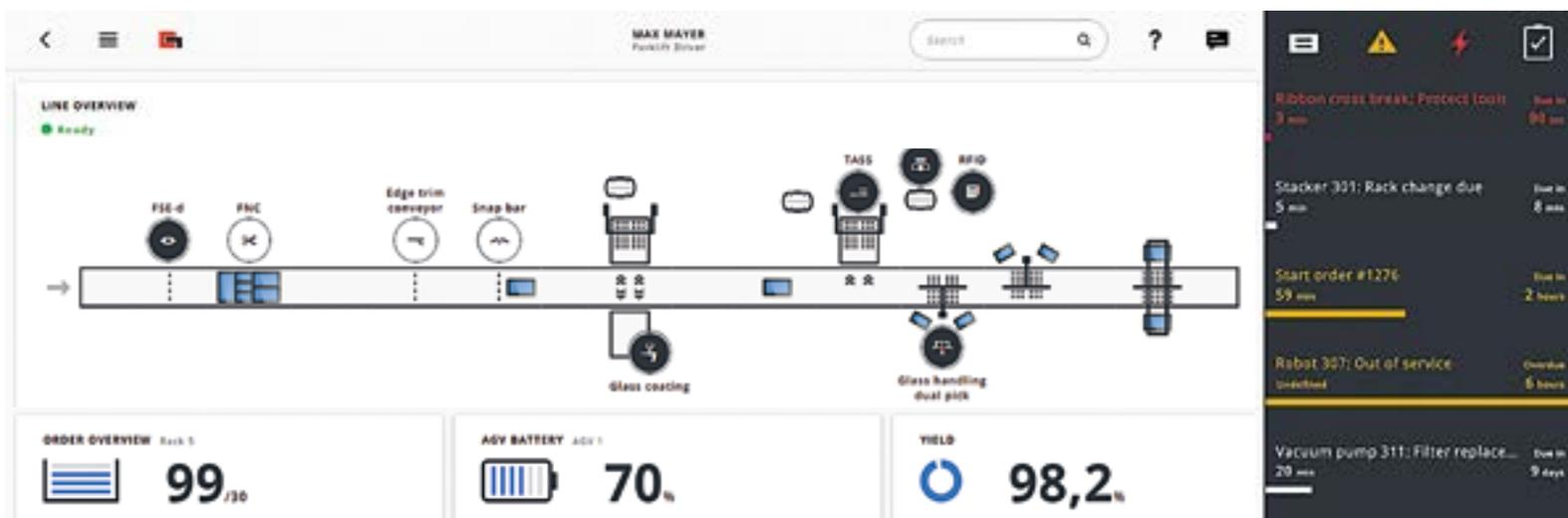
Visualisierung der Anlagenbeschickung und der aktuellen Zustände der AGVs
